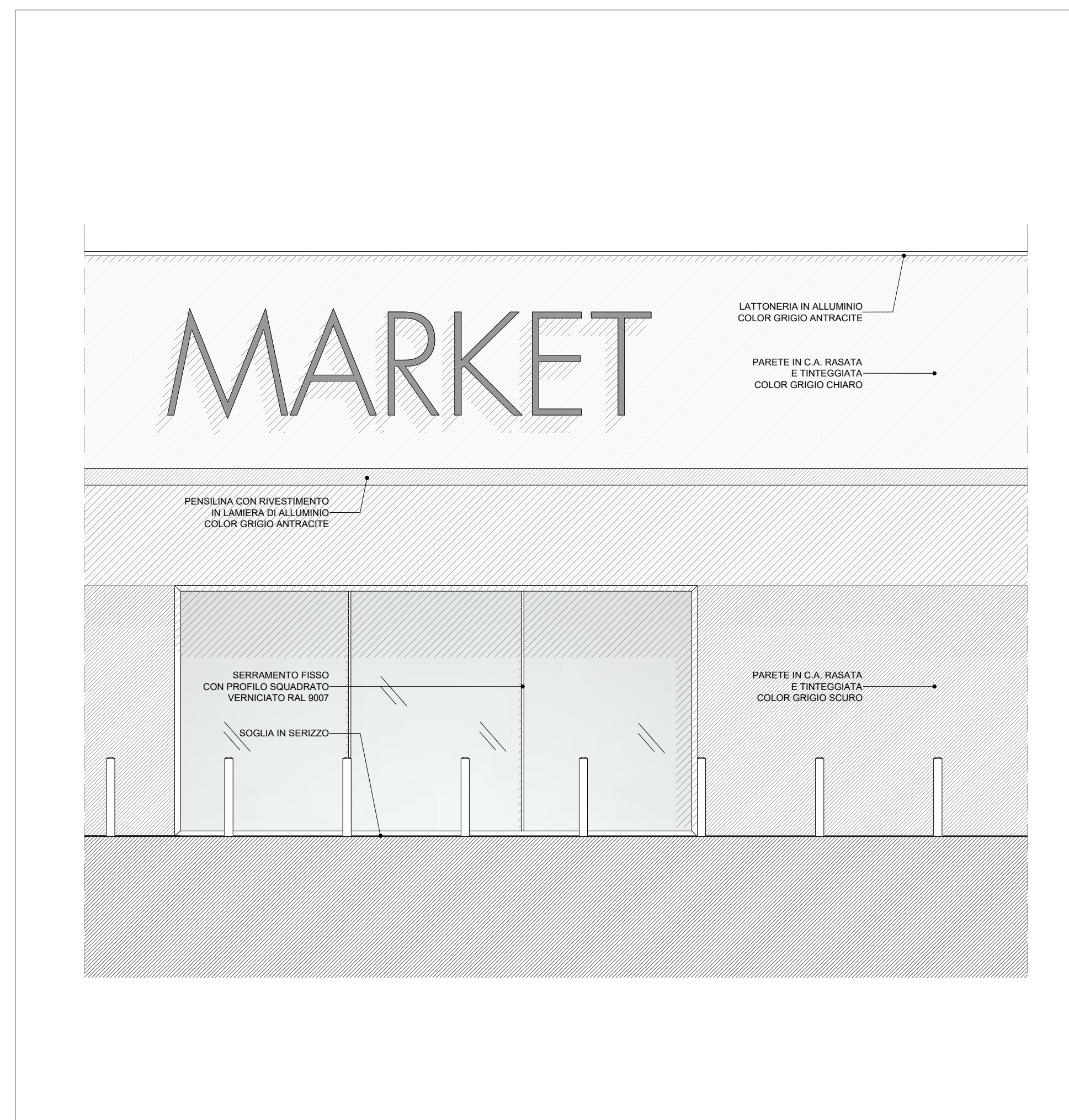
PARTICOLARE COSTRUTTIVO PROSPETTO EST - SCALA 1:50
